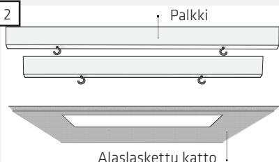
Mittaa neljän koukun paikat kattopalkkeihin ja kiinnitä ne.
