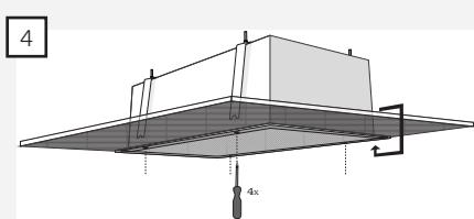
Ajustar los anclajes para que los cantos de la campana esten en línia con el techo. Hacerlo con un destornillador de estrella por los 4 agujeros de las esquinas.
