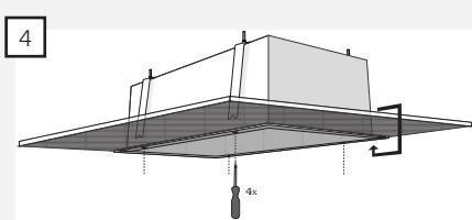
Sääädä kiinnikkeitä niin, että kuvun reuna on samassa tasossa katon kanssa. Tämä tehdään työntämällä ristipääruuvitalta kulmissa olevien neljä reiän läpi.
