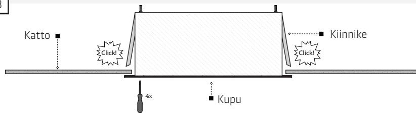
Kupua työnnetään sisään, kunnes kiinnikkeet napsahtavat kuvun kiinnitysrakenteen pääälle.
