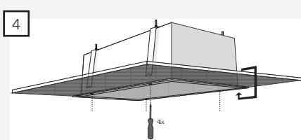
Juster beslagene så ventilatorenens kant flukter med tak/himling. Dette gjøres med en stjerneskruetrekker igjennom de fire hullene i hjørnene.
