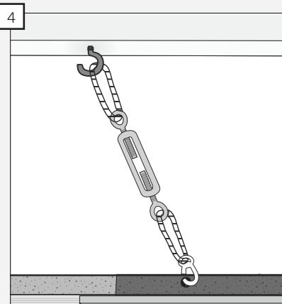
Fijar los cables para que los cantos del marco esten nivelados con el falso techo.
